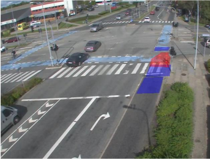
Figur 7 | Eksempel på udformning af detektorer i modul for ligeudkørende cyklister.
