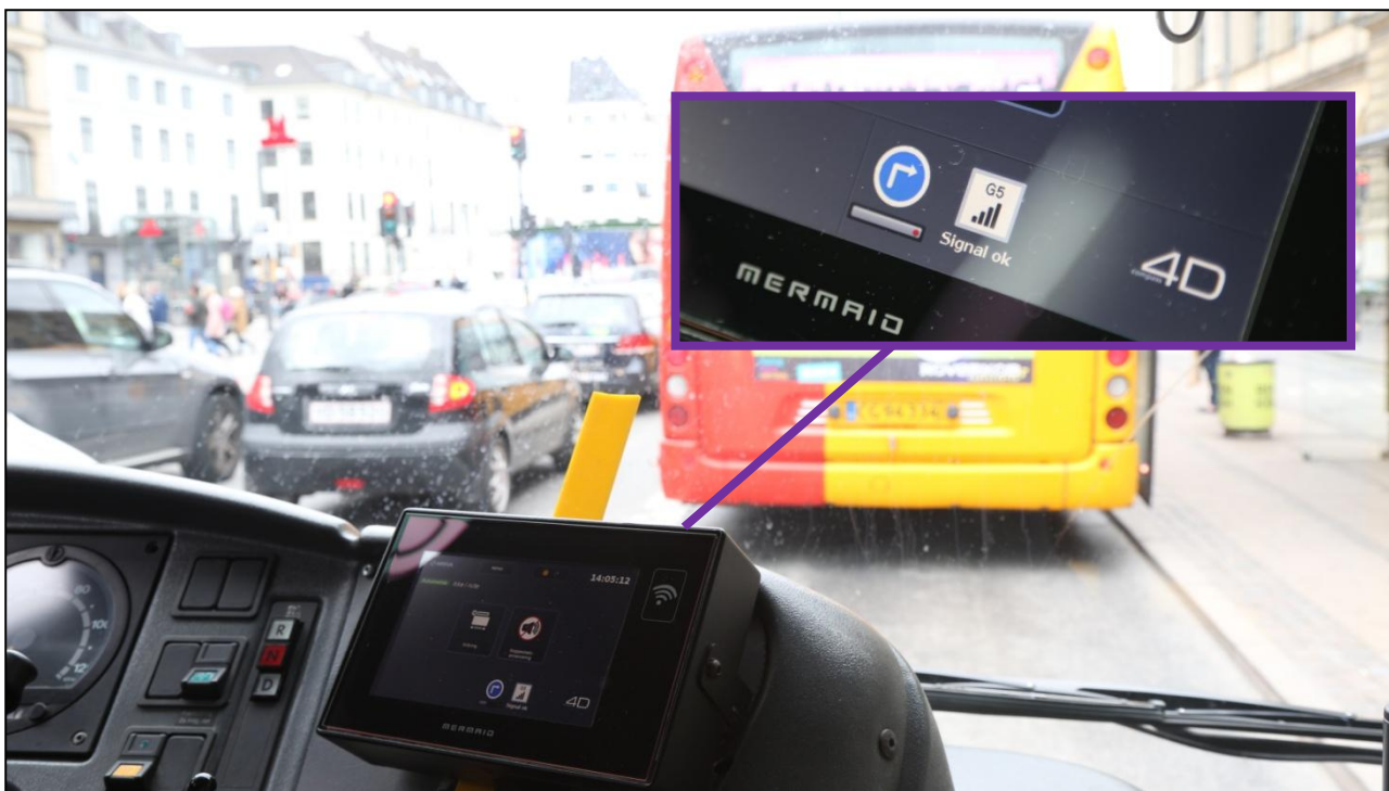
Skærm i buslinje 1A, hvorpå Compass4D informationerne præsenteres for chaufføren
